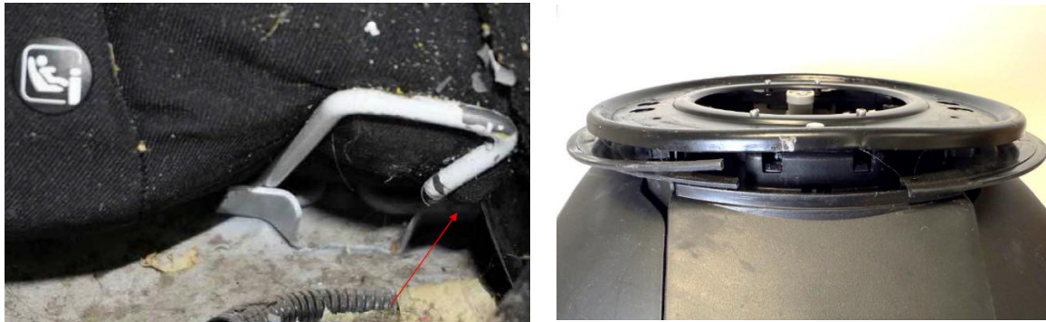
Mynd 6. Til vinstri sést aflöguð ISOFIX festing í bifreiðinni. Hægri mynd sýnir snúningsfestingu efri hluta barnabílstólsins og aflögun á henni.
