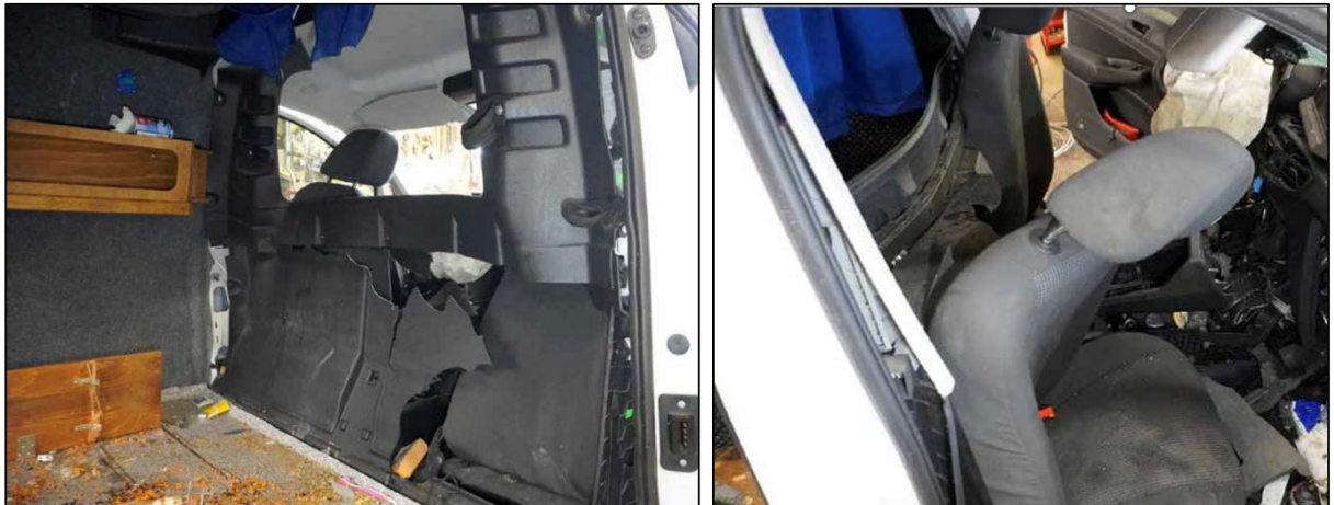
Mynd 4. Á mynd til vinstri má sjá hvernig skilrúmið gaf sig við áreksturinn og á mynd til hægri má sjá skilrúmið og hvernig sætin í farþegarýminu gáfu eftir.
