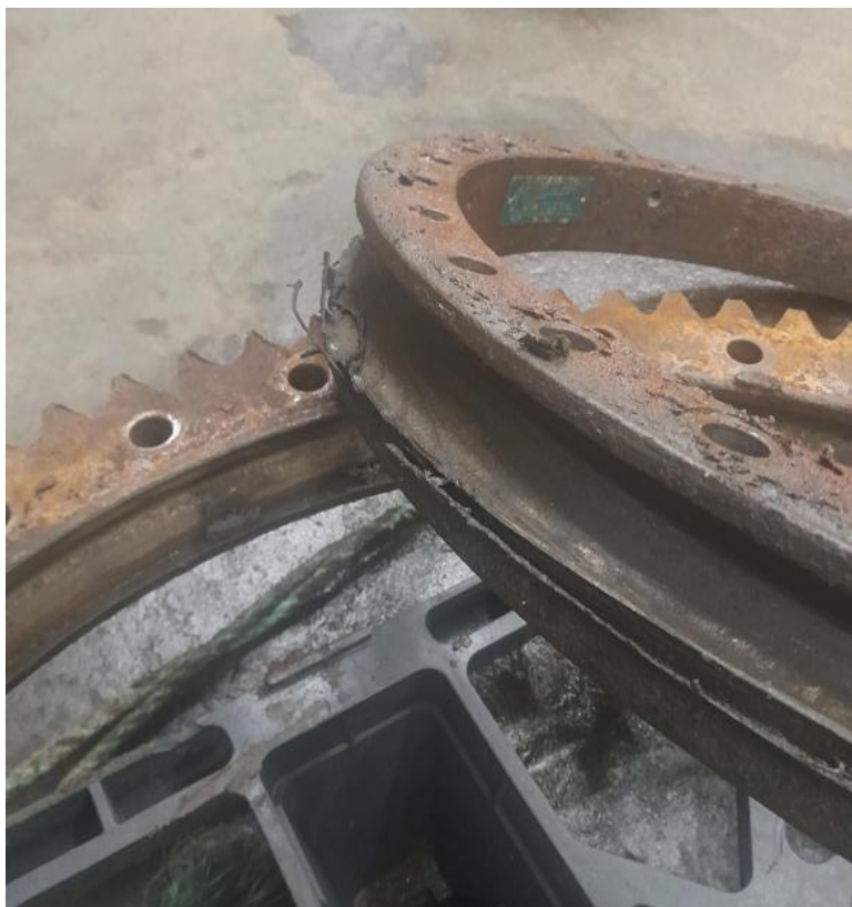
Mynd 6. Innri leguhringur sem festur er í kranann.
