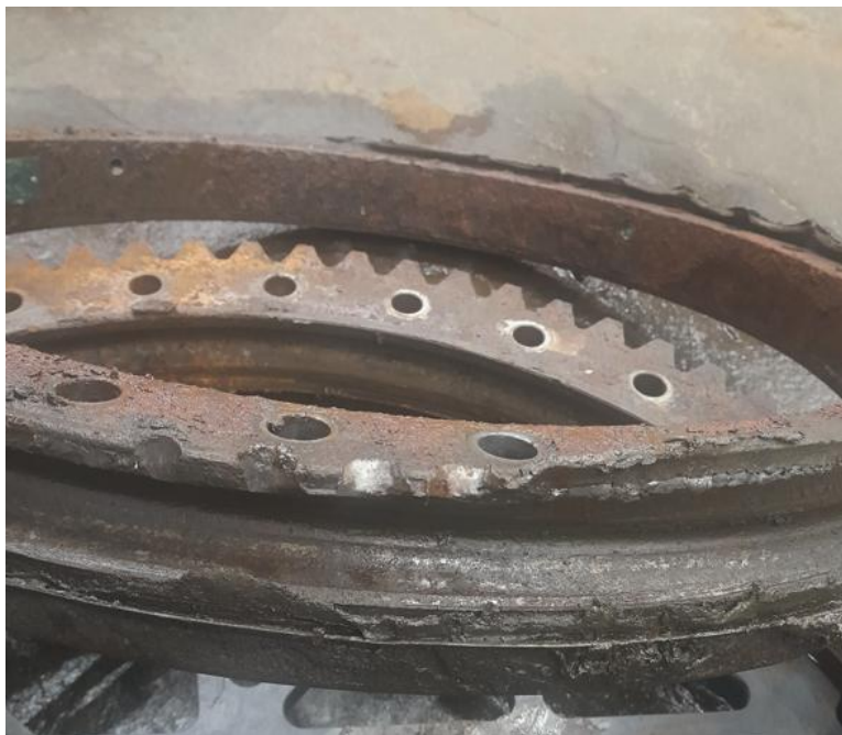
Mynd 5. Innri leguhringur sem festur er í kranann.
