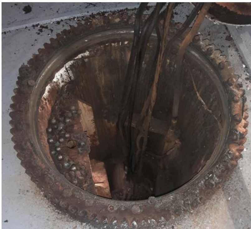
Mynd 4. Ytri leguhringur og tannkrans sem festur er í þilfar skipsins.
