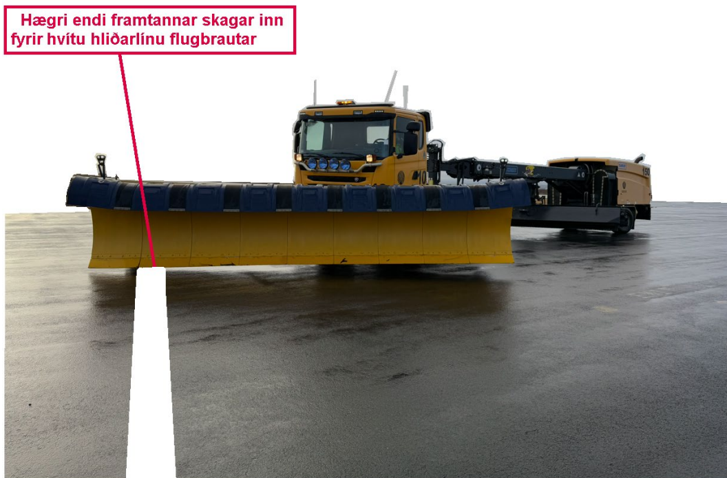
Mynd 5: Útskýring á því hvernig hægri endi framtannar tækis FROST 10 skagaði inn fyrir hliðarlínu flugbrautar 19 (ekki tekið að atviksstað við S-1 og hliðarlína teiknuð inn til útskýringar)
