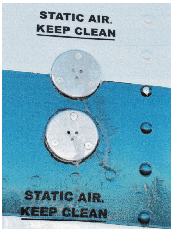
Mynd 2: Frosinn vökvi yfir loftþrýstingsskynjara (static air port)
