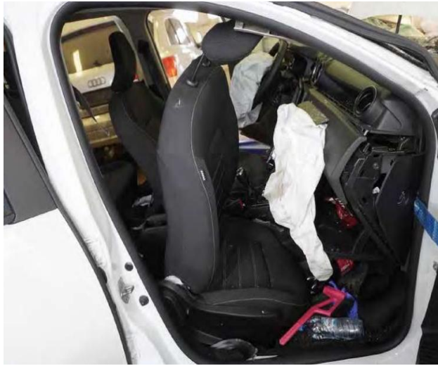
Mynd 3. Framfarþegasæti Dacia bifreiðarinnar var verulega úr lagi gengið eftir áreksturinn en festingar sætisins gáfu sig.
