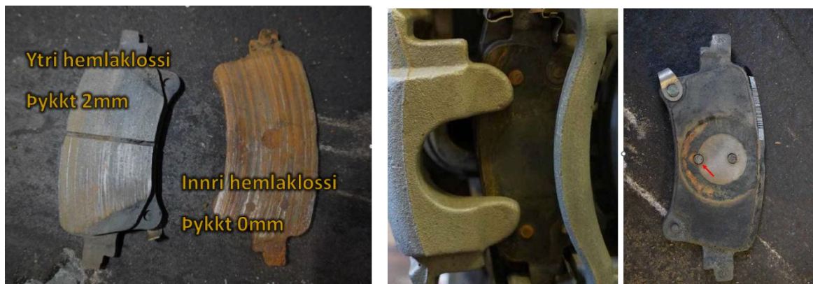
Mynd 8. Samsett mynd. Mynd til vinstri sýnir hemlaklossa vinstra megin að aftan á Jeep fólksbifreiðinni. Mynd til hægri sýnir hemlaklossa hægra megin að aftan. Þeim hafði verið víxlað við ísetningu.
