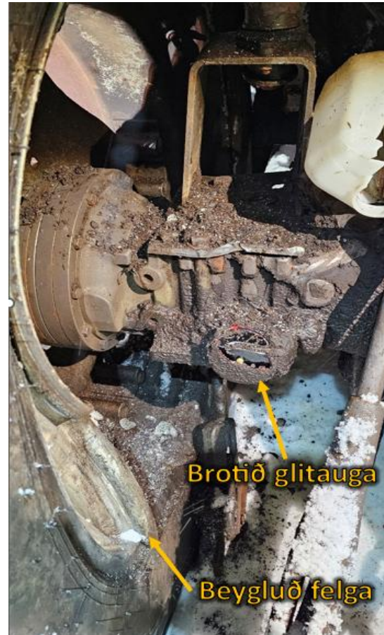
Mynd 6. Sýnir ákomu á dráttarvélinni. Glitauga vinstra megin brotnaði í árekstrinum.
