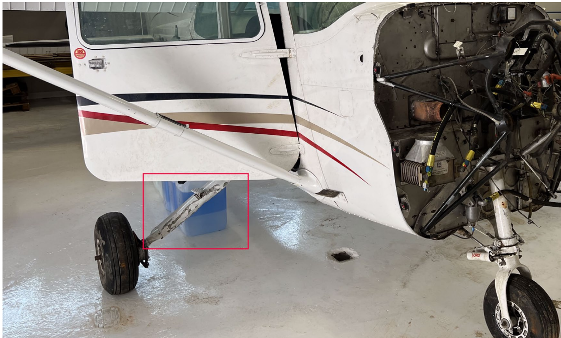
Mynd 14: Skemmdir á frambrún hægra aðalhjólaeggjar.
