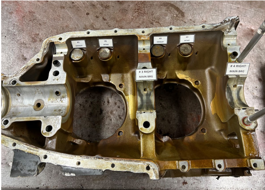
Mynd 90: Slit á legum sveifarás og á töppum við inntök fyrir strocka 1 og 3 við knastás.
