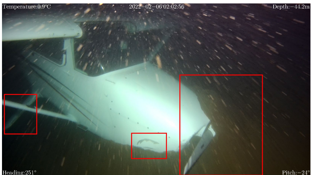
Mynd 48: Loftskúfa og skemmd á hægri aðalhjólalegg og hægri hlið vélarhlífar ofan botnsets.
