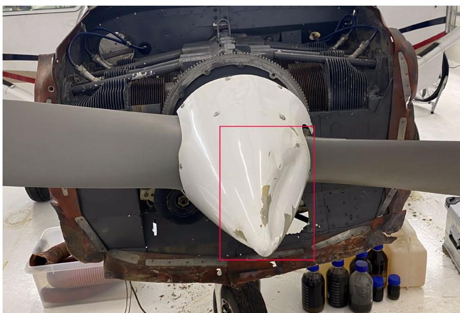
Mynd 11: Skemmd á snarkollu (spinner fairing).
