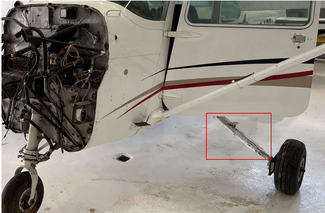
Mynd 16: Skemmdir á frambrún vinstri aðalhjólaeggjar.
