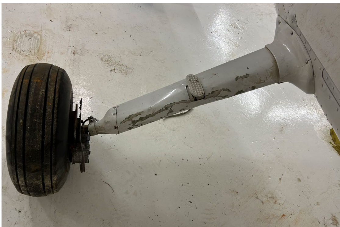
Mynd 15: Nærmynd af skemmdum á frambrún hægra aðalhjólaeggjar.
