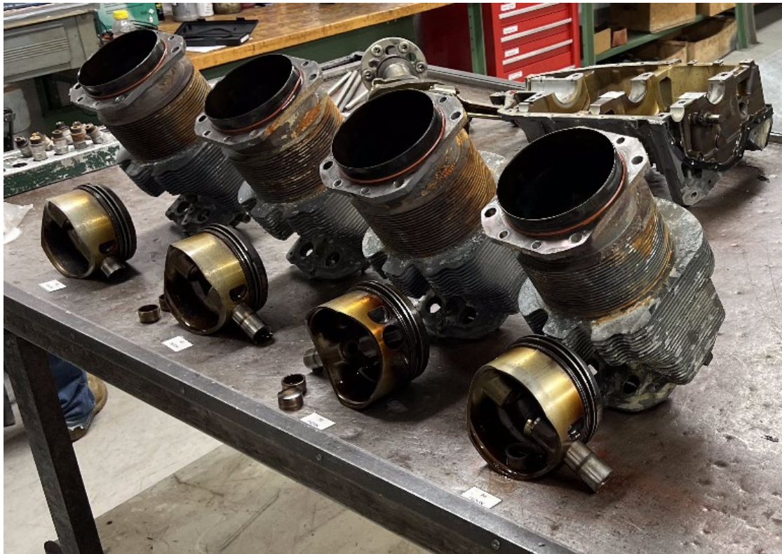
Mynd 88: Minniháttar tæring var á öllum strokkum.
