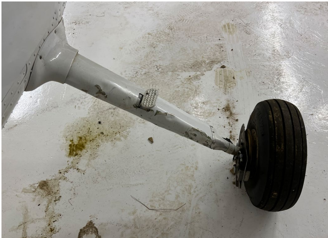
Mynd 17: Nærmynd af skemmdum á frambrún vinstri aðalhjólaeggjar.
