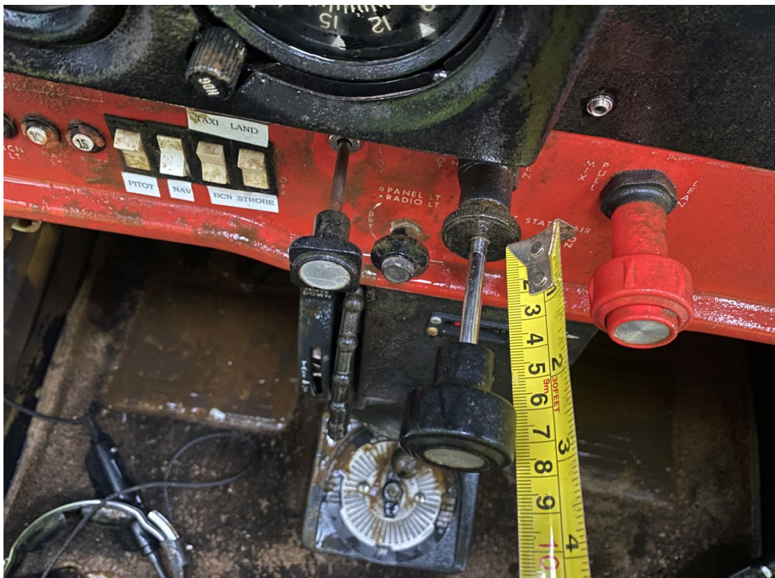
Mynd 39: Staðan á eldsneytisinnjöf, eldsneytisblöndu og blöndungshitara.
