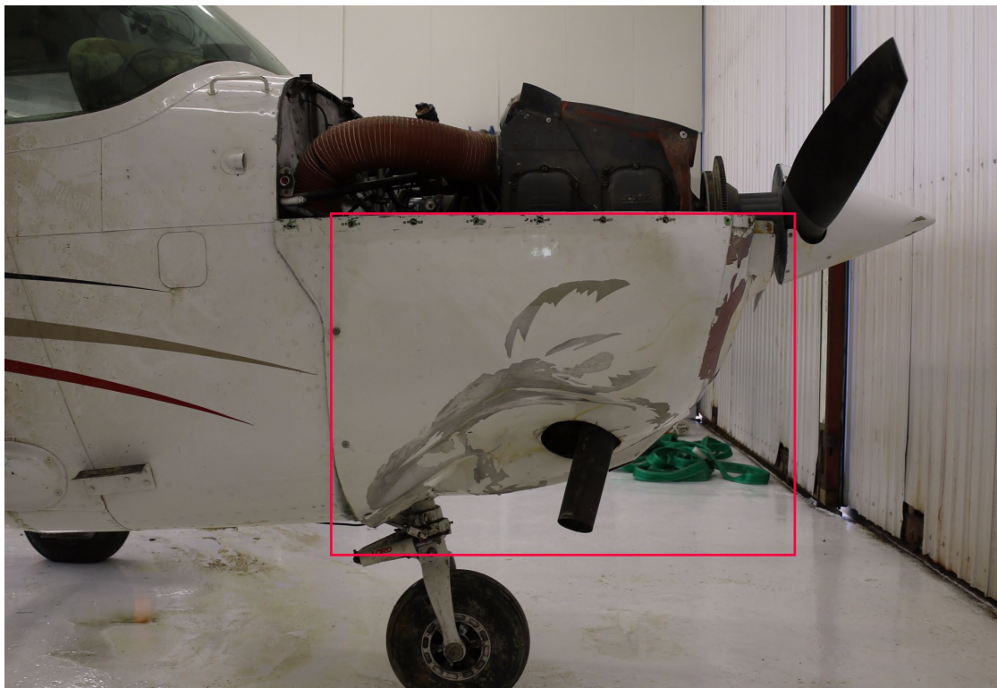
Mynd 13: Skemmd á neðri vélarhlíf (séð frá hægri hlið).
