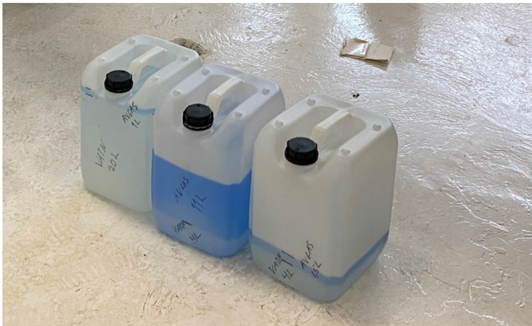
Mynd 65: Avgas 100 LL flugvélaeldsneyti (blátt) og vatn úr vinstri eldsneytisgeymi.
