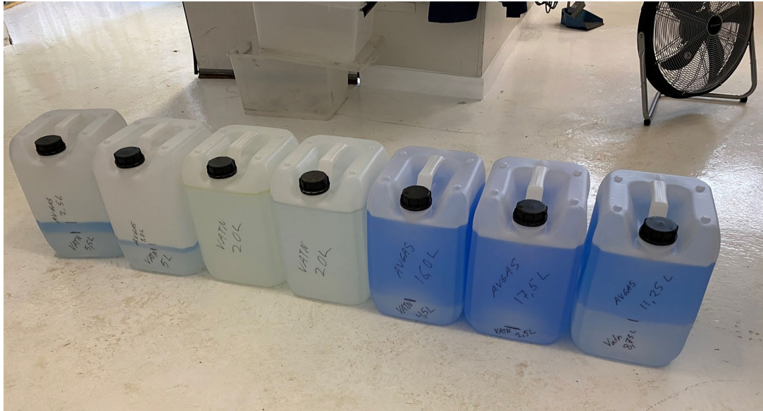
Mynd 64: Avgas 100 LL flugvélaeldsneyti (blátt) og vatn úr hægri eldsneytisgeymi.
