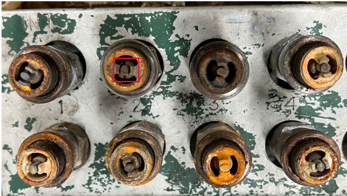
Mynd 87: Efra kerti nr. 2 var með skemmdu rafskauti.
