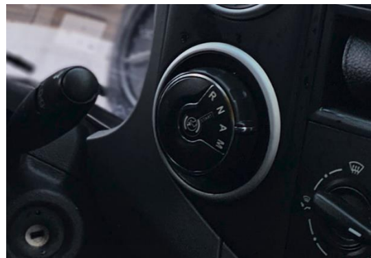
Mynd 2. Samsett mynd. Peugeot bifreiðin á vinstri mynd og stillihnappur fyrir sjálfvirka kúplingu í henni á hægri myndinni.
