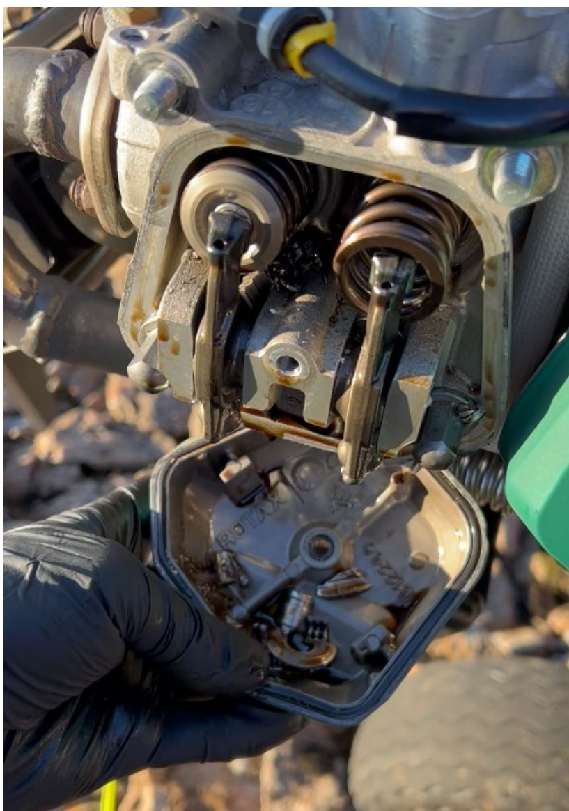
Mynd 5: Brotinn gormahaldari fyrir ventil á strokki nr. 2
