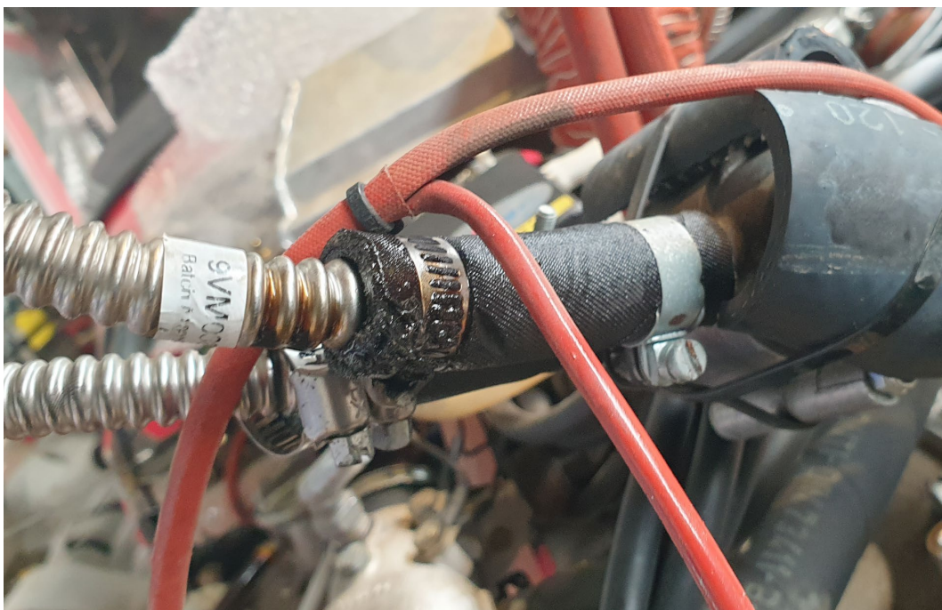
Mynd 9: Olíusmit á tengjum fyrir olíuleiðslu hreyfilsins
