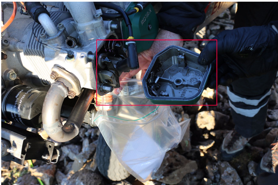
Mynd 7: Olíusmurningu vantaði að mestu leyti á strokki nr. 2
