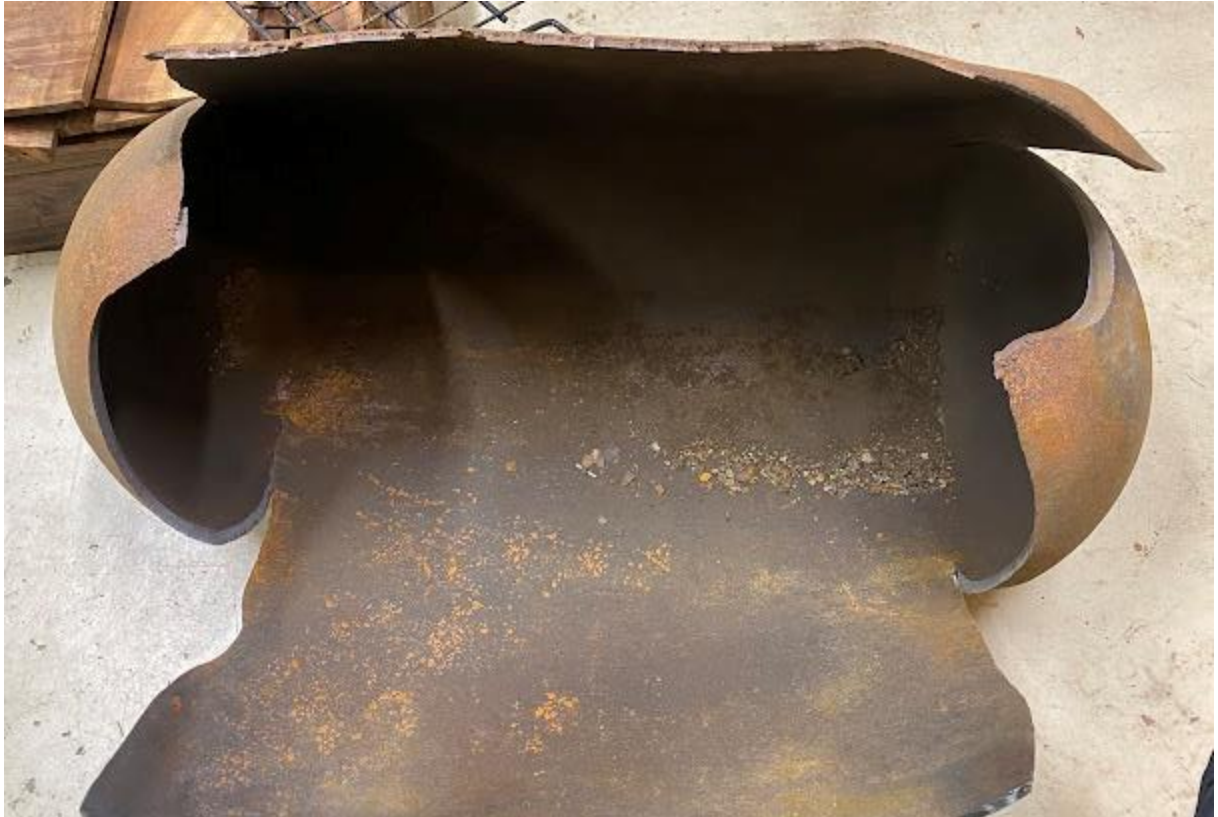
Mynd 3. Mynd af geyminum sem sprakk, rifa kom upp langsum eftir honum þar sem hann var mest tærður.
