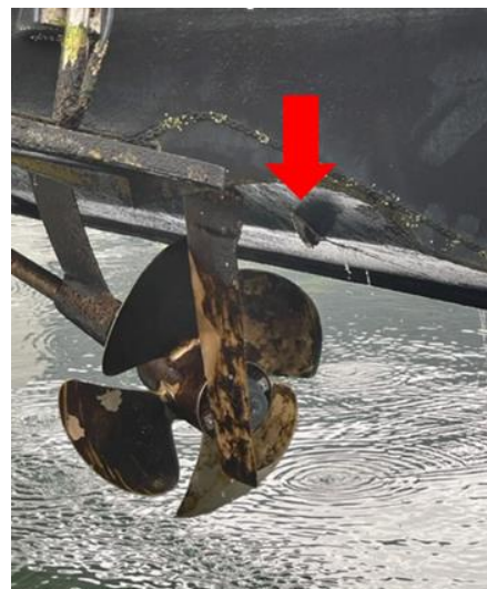
Myndin sýnir bakborðsskrúfubúnað. Rauða örin sýnir hvar skrúfan gerði gat á skrokkinn.
