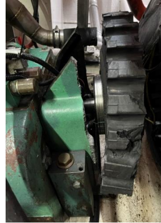
Myndin sýnir gírinn fyrir bakborðsvél og skrúfuöxullinn genginn aftur.
