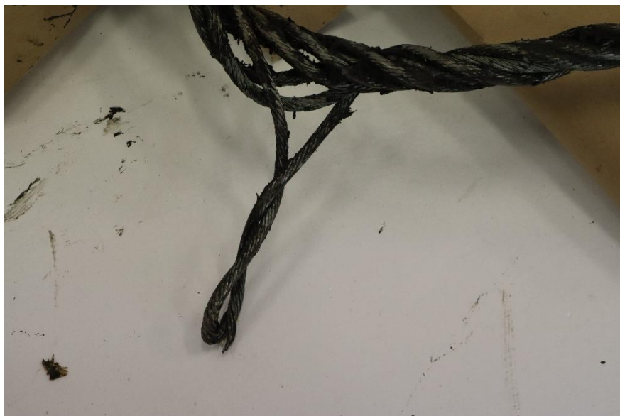
(Mynd 5) Vírinn stutt frá þeim stað sem hann slitnaði.
