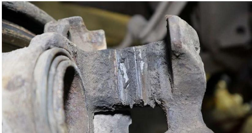
Mynd 3: Hemladælan hægra megin að aftan. Ummerki eru um að hemladiskurinn hafi sorfið hemladæluna.
