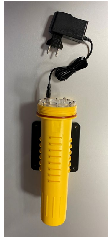
Mynd 2 ONWA netabauju staðsetningarbúnaður með hleðslutæki
