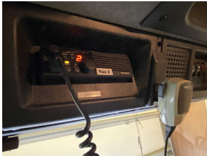
Mynd 2: Föst talstöð í sandara fyrir bílabylgju 168,6 MHz
