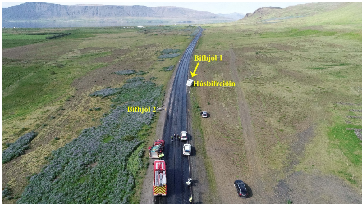
Mynd 1: Mynd tekin í akstursátt húsbifreiðarinnar af vettvangi slyssins. Malbiksblæðingar eru áberandi í hjólförum á báðum akreinum.
