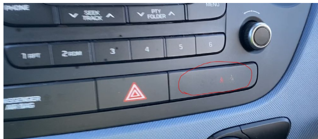
Mynd 2: Undir útvarpinu í bifreiðinni eru ljós sem sýna hvaða belti er í notkun.
