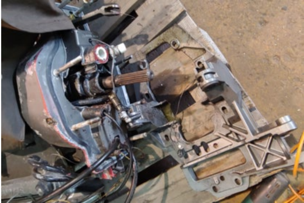
Myndin sýnir hældrifið og brotna gaflstykkið, partur af gaflstykkinu er upp á driföxlinum.
