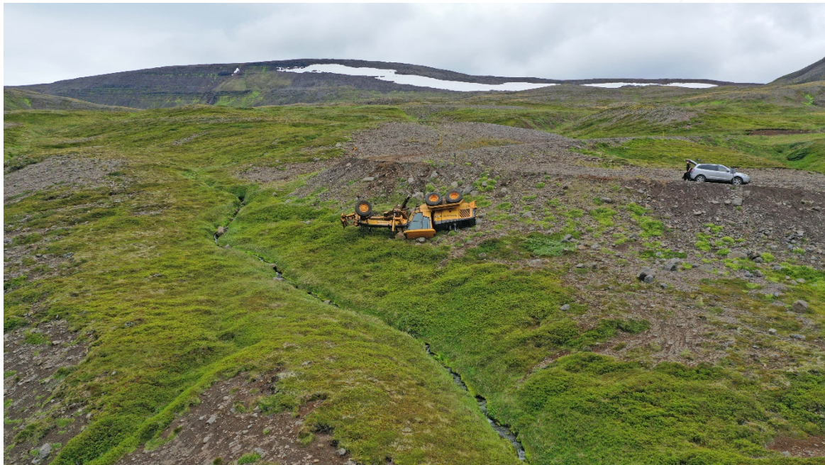
Mynd 1: Mynd af vettvangi slyssins. Veghefillinn rann aftur á bak út fyrir veginn og valt.
