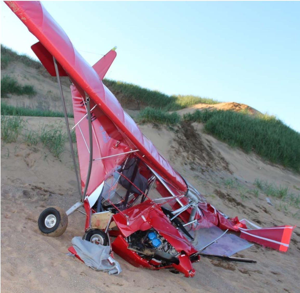
Mynd 11: Skemmdir á fisinu eftir brotlendingu - Búið er að draga það úr flæðamáli
