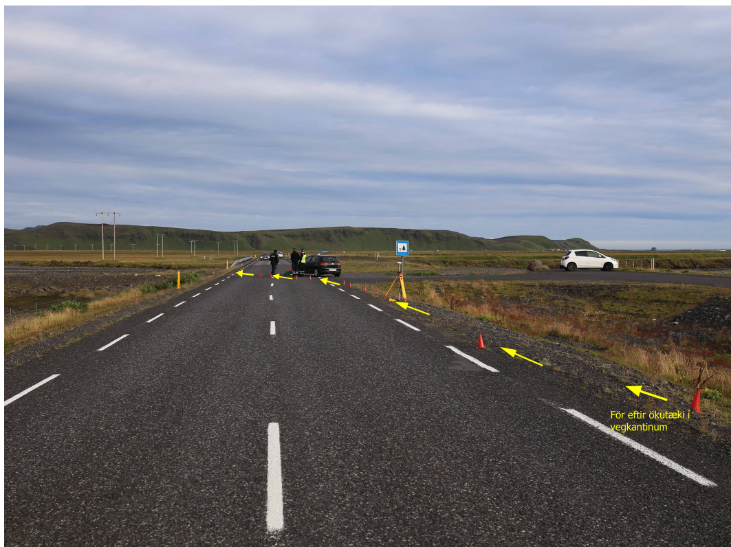
Mynd 1. För eftir bifreiðina í hægri vegkanti og þvert yfir veginn til vinstri.
