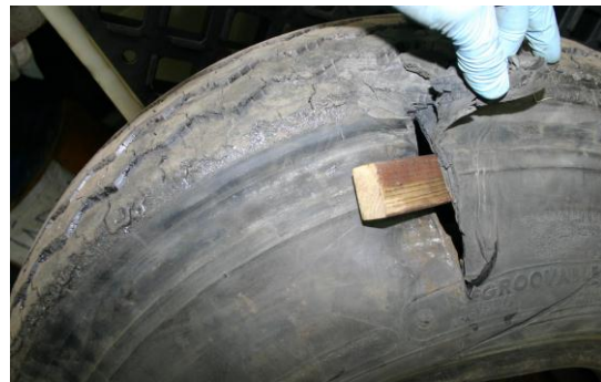
Mynd 4. Rifa í hjólbarða og nuddföer eftir vagninn. Hjólbarðinn var á aftasta ási vinstra megin á vagninum.
