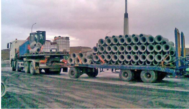
Mynd 9. Sýnir fyrstu hleðslu steinröra á vagninn. færð frammar á vagninn.
