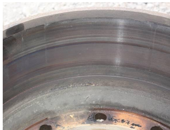
Mynd 4: Hemlaskálin hægra megin að framan. Greinilegur blámi var á slitfleti hennar.
