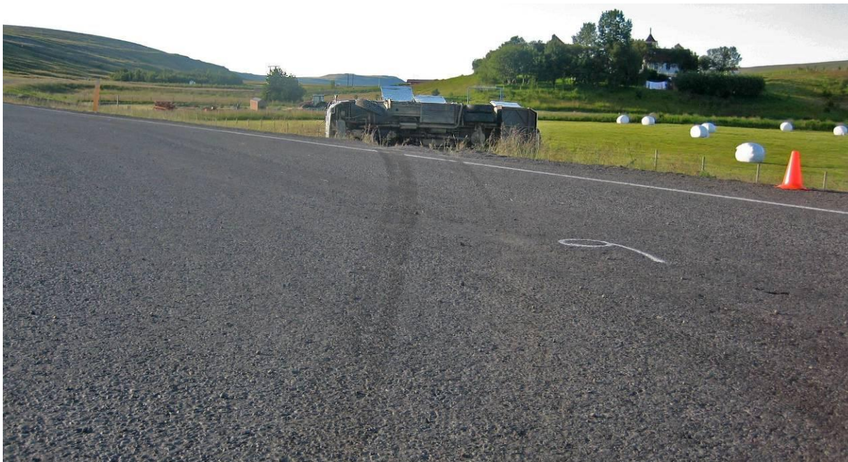
Mynd 3: Myndin var tekin á gatnamótunum af hópbifreiðinni þar sem hún stöðvaðist. Skriðför eftir hana sjást greinilega á malbikinu.. Mynd fengin frá lögreglu.
