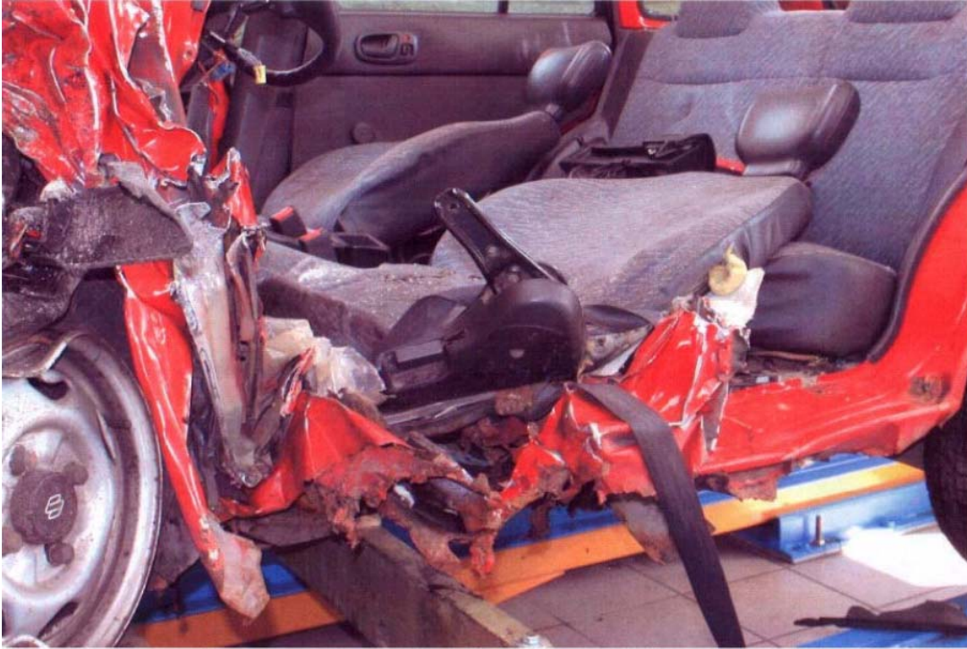
Mynd 46. Sils vinstra megin. Ryðmyndunin er algjör í framhluta og einungis þröskuldur undir afturhurð sýnist heillegur en er verulega ryðgaður að innanverðu. Ryðmyndunin hefur rúið silsinn og neðri hluta A- og B-stafanna styrk sínum algjörlega.
