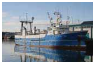
Skipaskr.nr. 1275 Smiðaður: Muroran Japan 1972, stál Stærð: 548,4 brl. 808,8 bt. Mesta lengd: 55,82 m Skráð lengd: 51,45 m Breidd: 9,5 m Dýpt: 6,5 m Vél: Niigata 1691kW, 1986 Fjöldi skipverja: 13
