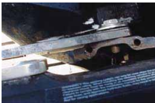
Tenging á stýrissveif og stýristjakk splitttróna og neðri skifu vantar
