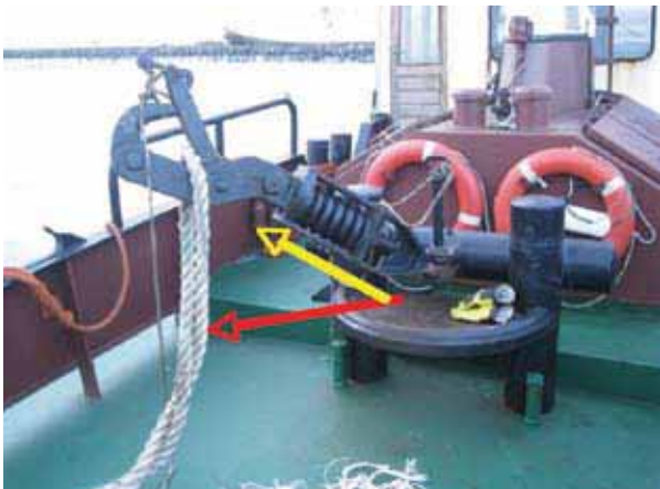
Skemmdir á dráttarbúnaði (rauða línan sýnir u.þ.b. rétta stöðu) ©Útgerð
