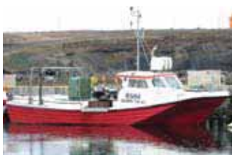
Skipaskr.nr. 6584 Smíðaður: England 1984, plast Stærð: 9,2 brl. 9,9 bt. Mesta lengd: 9,88 m Skráð lengd: 9,8 m Breidd: 3,34 m Dýpt: 1,48 m Vél: Iveco 162 kW, 1984 Fjöldi skipverja: 2
