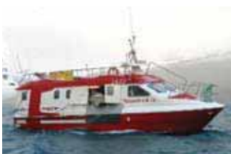
Skipaskr.nr. 2652 Smíðaður: Akranesi 2006, plast Stærð: 11,3 brl. 14,7 bt. Mesta lengd: 12,74 m Skráð lengd: 10,96 m Breidd: 3,94 m Dýpt: 1,56 m Vél: Yanmar 314 kW, 2006 Fjöldi skipverja: 4
