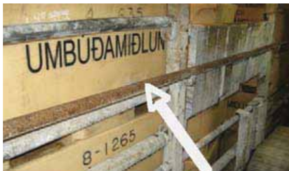
Sjóbúnaðarstangir upp settar ásamt „handlista“ (ör) til stuðnings í gangveginum.
