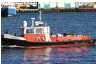
Skipaskr.nr. 2052 Smíðaður: Akranesi 1990, stál Stærð: 17,8 brl. 25,2 bt. Mesta lengd: 14,25 m Skráð lengd: 13,83 m Breidd: 4,26 m Dýpt: 1,75 m Vél: Caterpillar 260 kW, 1990 Fjöldi skipverja: 2
