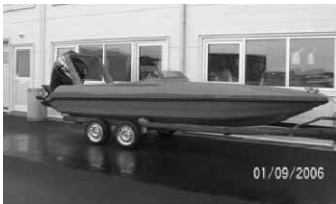
Skipaskr.nr. Óskráður Smíðaður: Akureyri 1998, plast Mesta lengd: 6 m Breidd: 1,5 m Vél: Evinrude E-Tec 165 kW, 2005 Fjöldi skipverja: 1
