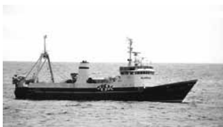
Skipaskr.nr. 1472 Smíðaður: Gdynia Póllandí, 1977 Stærð: 488,0 brl. 744,7 bt. Mesta lengd: 51,83 m Skráð lengd: 44,71 m Breidd: 10,76 m Dýpt: 6,96 m Vél: B&W Alpha 1987, 1620 kW Fjöldi skipverja: 6
