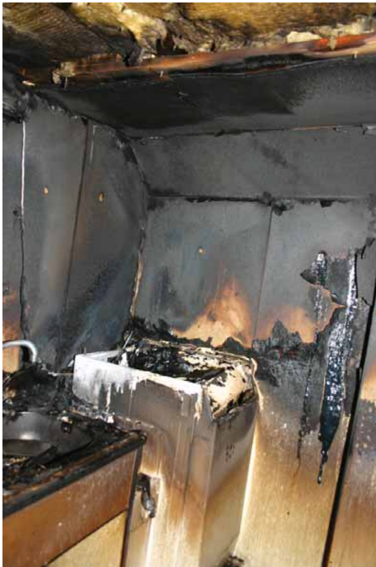
Eldur varð laus um borð í Beiti NK 123 (mál nr. 13406) sem rakin var til bilunar í þvottavél. Myndin sýnir þvottavélina og umhverfi hennar.
