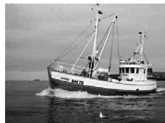
Skipaskr.nr. 1547 Smíðaður: Hafnarfirði 1979, Eik Stærð: 24,3 brl. 22 bt. Mesta lengd: 15,77 m Skráð lengd: 14,68 m Breidd: 4,26 m Dýpt: 1,93 m Vél: Cummins 224 kW, 1997 Fjöldi skipverja: 2
