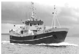
Skipaskr.nr. 1028 Smíðaður: Þýskalandi 1967, stál Stærð: 253,8 brl. 383 bt. Mesta lengd: 39,46 m Skráð lengd: 36,8 m Breidd: 7,2 m Dýpt: 6,1 m Vél: Caterpillar 626 kW, 1981 Fjöldi skipverja: 10
