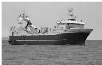
Skipaskr.nr. 2212 Smíðaður: Stál, Flekkefjord Noregi 1994 Stærð: 1.514 brl. 2.968 bt. Mesta lengd: 85,85 m Breidd: 14 m Dýpt: Vél: MaK, 4..500 kW, 1994 Fjöldi skipverja: 16
