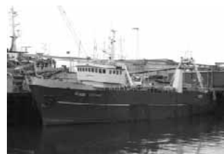
Skipaskr.nr. 1337 Smíðaður: Noregi 1972, stál Stærð: 299,2 brl. 508,4 bt. Mesta lengd: 45,41 m Skráð lengd: 40,94 m Breidd: 9,2 m Dýpt: 6,5 m Vél: Crepelle 1360 kW, 1986 Fjöldi skipverja: 0
