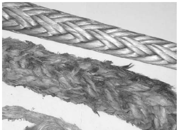
Myndin sýnir 24 mm DYNEX 75, nýtt og það sem notað var um borð í Ásgrími
