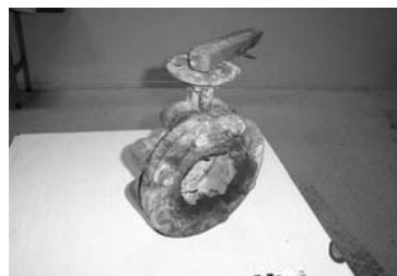
Mynd 2. Spjaldloki og flangs ryðbrunninn frá röri, snéri niður
