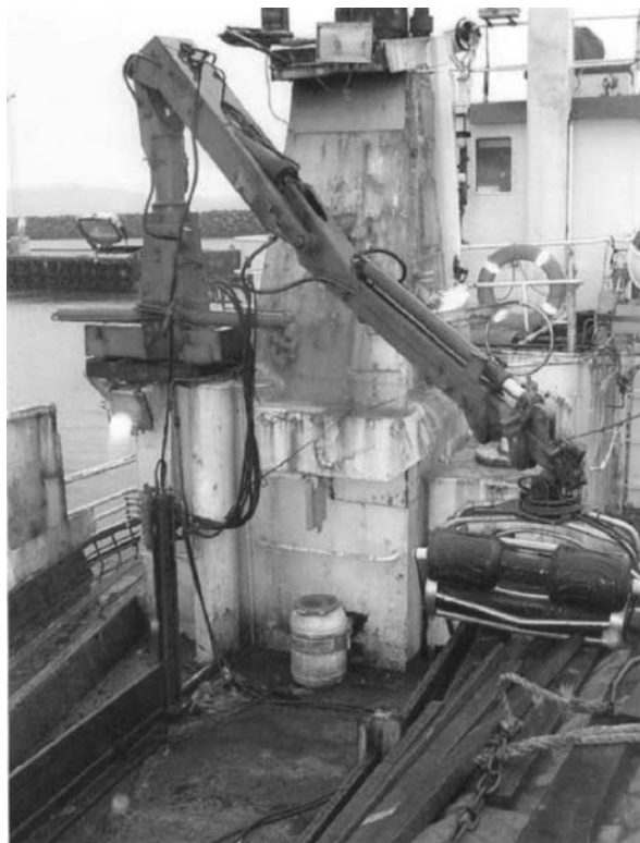
Myndin sýnir olíusmit (glussa) á þilfari og í kringum stjórntök.
