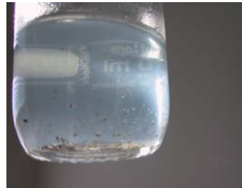
Sýni með óhreinindum tekið úr blöndungsbolla (strainer) áður en hann var opnaður.
