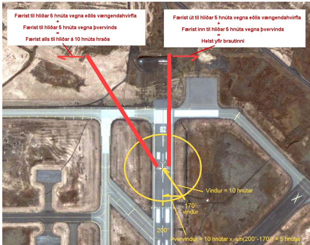
Mynd 1: Áætlaðir vængendahvirflar Airbus 319 flugvélarinnar
