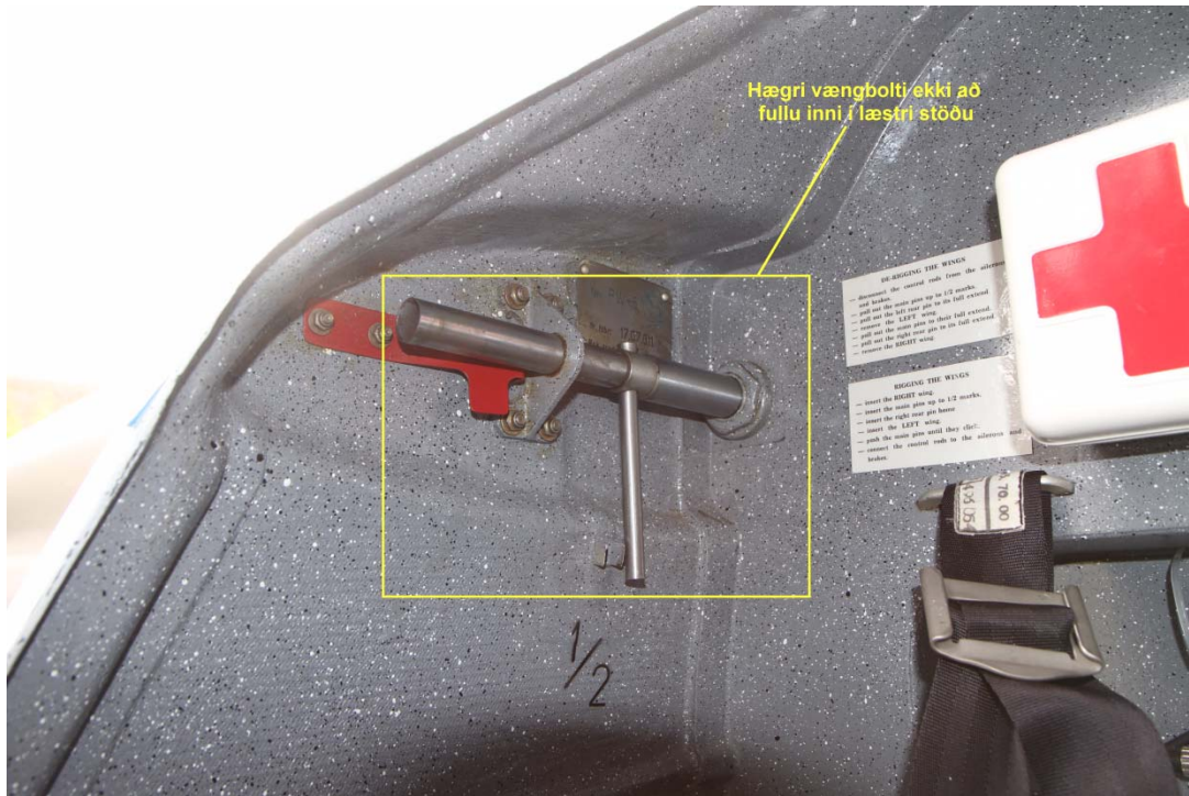
Mynd 2: Hægri aðal vængbolti ekki að fullu inni í læstri stöðu
