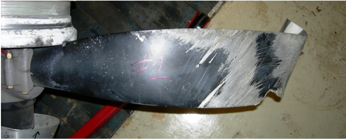
Mynd 10. Skrúfublað sem líklega snerti jörðina fyrst. Blaðið er bogið fram sem bendir til þess að afl hafi verið á hreyflinum.
