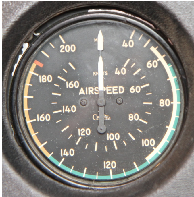
Mynd 4: Á hraðamæli loftfarsins má sjá hnúta á innri skala og MPH á ytri skala
