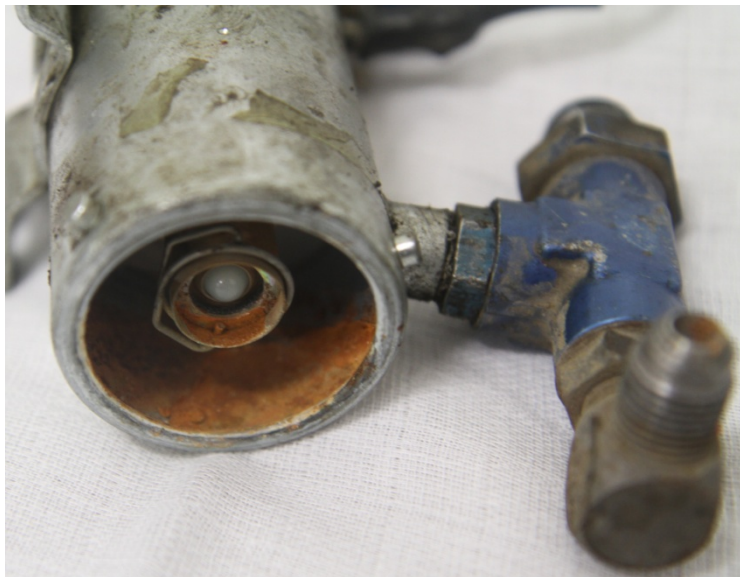
Mynd 9: Á myndinni má sjá ryð í rafmagnseldsneytisdeilunni
