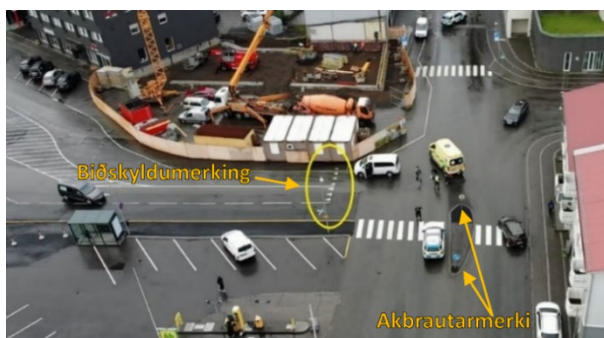
Mynd 3. Biðskyldumerking á tveimur syðri akreinum við gatnamótin (gulur hringur) og akbrautarkerki á Strandgötu.
