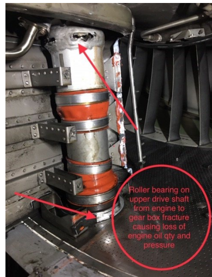
Mynd 1 Á myndinni má sjá að keflalega hafði gefið sig
