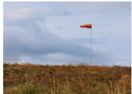
Mynd 7: Um 15 hnúta vind þarf til að vindpoki sé fullstrektur.
