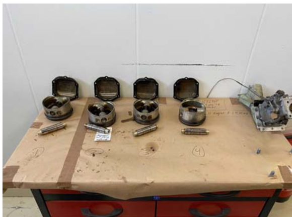
Mynd 19: Bullur, bulluvölur, strokkar og kerti vinstri hreyfils voru í lagi
