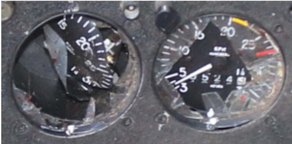
Mynd 8: Snúningshraðamælar (RPM) fyrir vinstri og hægri hreyfil
