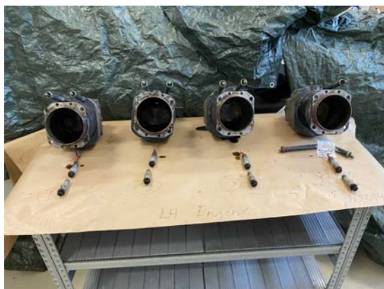
Mynd 19: Bullur, bulluvölur, strokkar og kerti vinstri hreyfils voru í lagi
