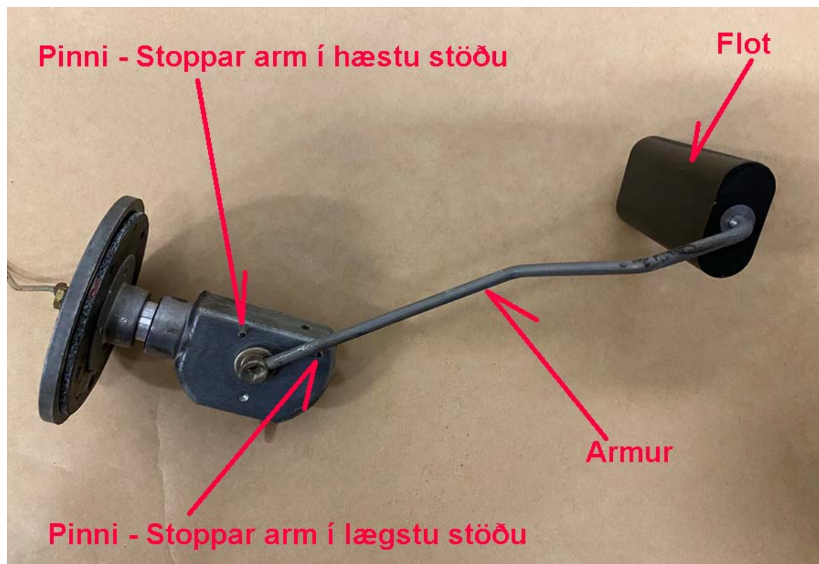
Mynd 33: Eldsneytisnemi úr eldsneytisgeymi (fuel quantity transmitter unit)
