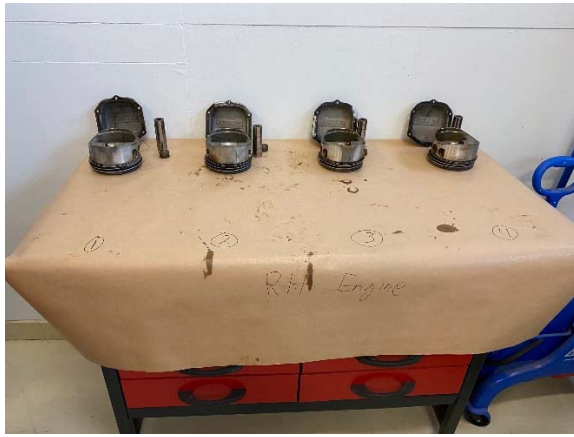
Mynd 22: Bullur, bulluvölur, strokkar og kerti hægri hreyfils voru í lagi
