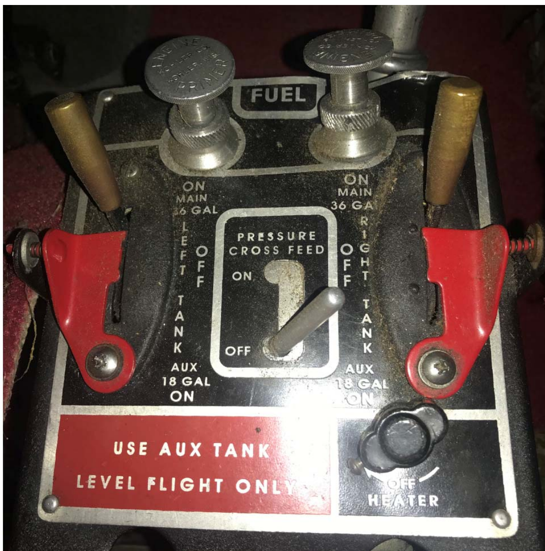
Mynd 11: Eldsneyti til hreyfla frá aðaleldsneytisgeymum
