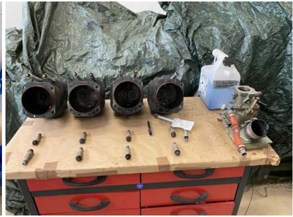
Mynd 22: Bullur, bulluvölur, strokkar og kerti hægri hreyfils voru í lagi
