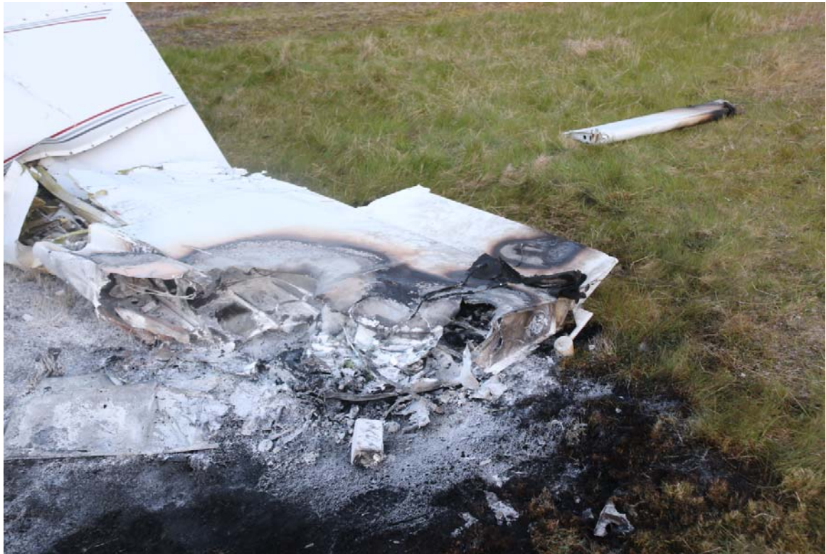
Mynd 6: Eldur kviknaði í eldsneyti í varaeldsneytisgeymi nálægt vinstri vængenda
