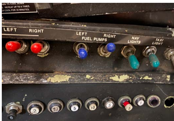
Mynd 10: Hægri varaeldsneytisdælan var á (ON)
