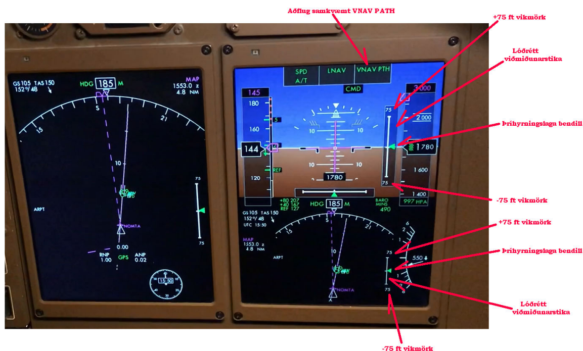
Mynd 17: Útskýring á lóðréttum leiðsöguferli (VNAV PATH) á aðalupplýsingaskjá (úr hægra sæti B757 flughermis í Hafnarfirði, sem útbúinn er flatskjám) (hafa ber í huga að flugvél TF-ISR var útbúin skjáklefa)
