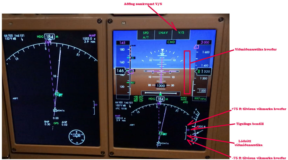
Mynd 18: Útskýring á fallhraða (V/S) á aðalupplýsingaskjá (úr hægra sæti B757 flughermis í Hafnarfirði, sem útbúinn er flatskjám) (hafa ber í huga að flugvél TF-ISR var útbúin skjáklefa)
