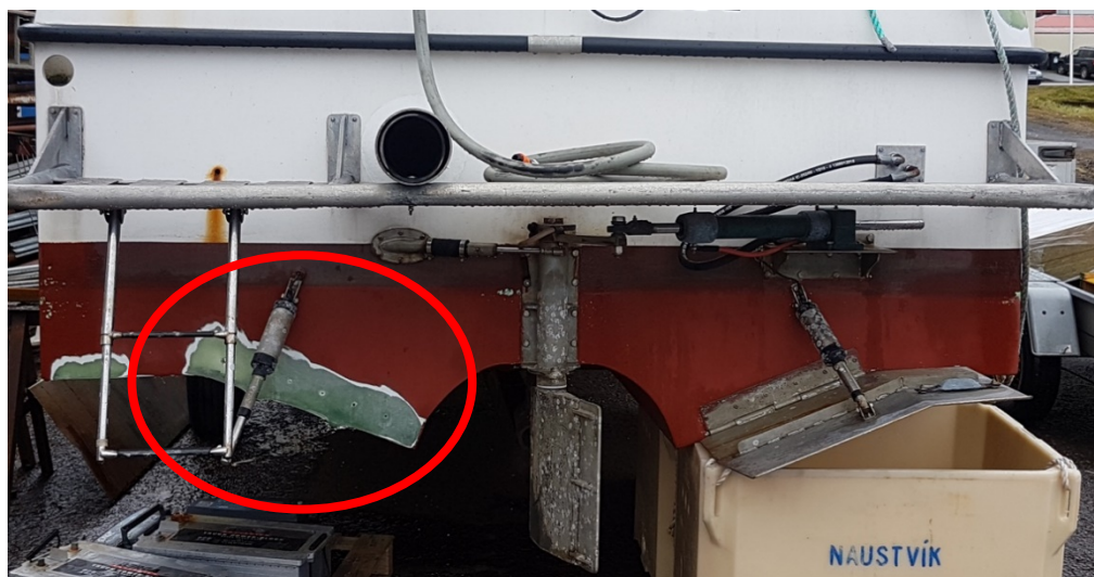
Myndin sýnir skut bátsins þar sem vantar bb skriðbrettið.
