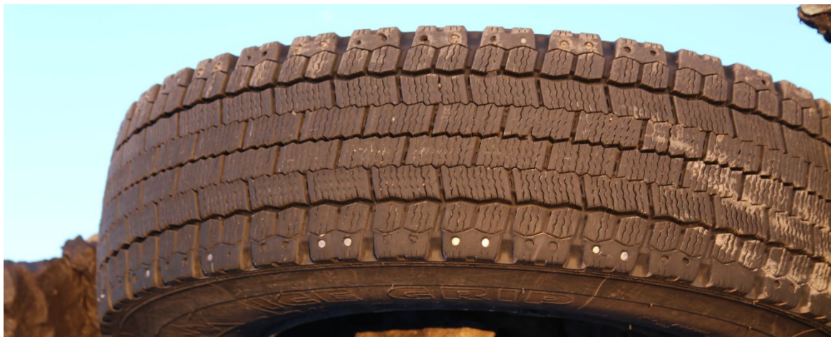
Mynd 6: Framhjól hægra megin. Einungis voru 19 heilir naglar eftir af 146.
