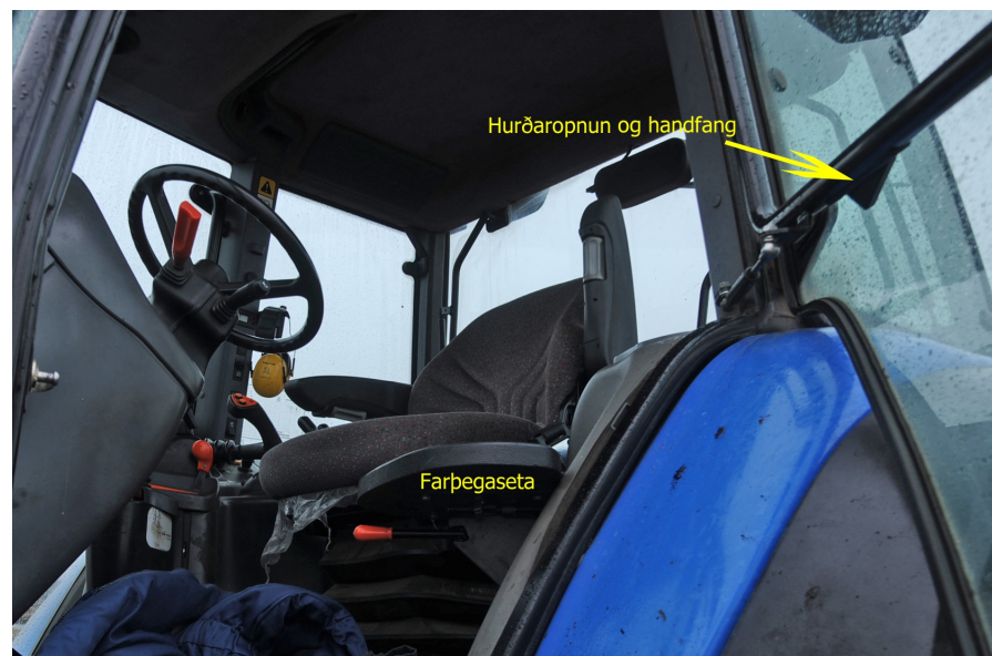
Mynd 2. Hurð New Holland vélarinnar og hurðarlæsing.
