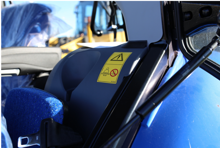
Mynd 4. Farþegaseta með bílbelti og varúðarmerking í New Holland T-5 vél (árg. 2016).
