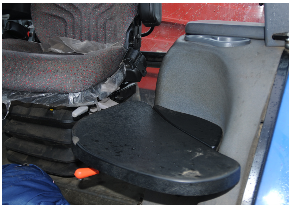
Mynd 3. Farþegaseta. Engin öryggisbúnaður er fyrir farþega í vélinni.
