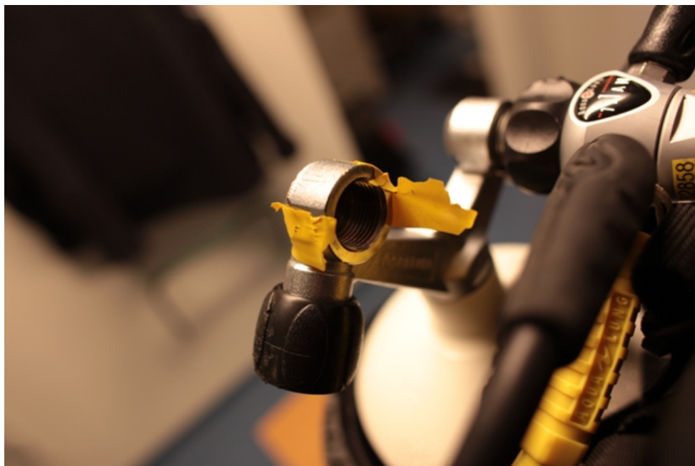
Aðeins sést á krananum og einangrunarbandið rofið. Krani full opinn. Mynd 1
