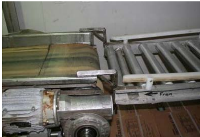
Samtenging færibandsins og keflabrautarinnar þar sem fætur slasaða festust á milli.
