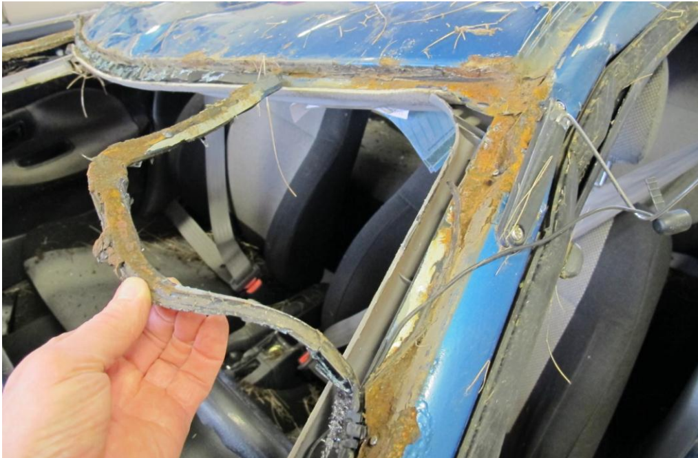
Mynd af framrúðufalsi bifreiðarinnar. Sjá má að ryð er komið undir borðann og hann því laus frá falsinu. Mynd fengin úr bíltækniskýrslu.
