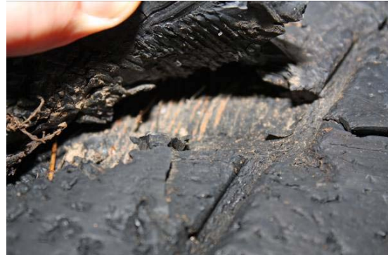
Mynd tekin af hjólbarðanum. Sjá má hvernig mynstursflöturinn var sprunginn niður í víralagið. Víða var sólinn farinn að losna frá víralaginu.
