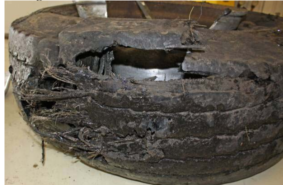
Mynd af sprungna hjólbarðanum. Sjá má stórt gat þvert á slitfleti hans.
