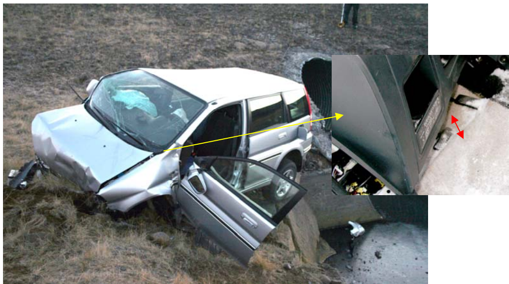
Mynd 3. Framendi bifreiðarinnar afmyndaðist mikið við áreksturinn. Mælaborð bifreiðarinnar gekk aftur að ökumanni og gólfið færðist upp þannig að hemlafetill og bensínjölf námu við gólf eins og sést á minni myndinni.
