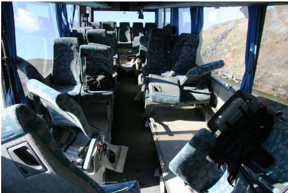
Mynd 3. Horft aftur í hópbifreiðina. Sætisbekkir losnuðu þar sem festingar voru ekki tryggar.
