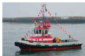
Magni Skipaskr.nr.: 2686 Smiðaður: Rúmeníu 2006 stál Stærð: 122,70 brl; 141,20 bt Lengd: 22,00 m Breidd: 7,80 m Dýpt: 3,74 m Vél: Caterpillar 954,00 kW Árgerð: 2006 Fjöldi skipverja:
