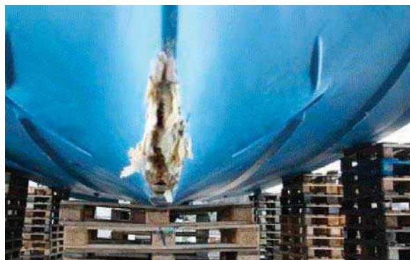
Skemmdir á stefni, fyrir neðan perustefni ©Lögreglan
