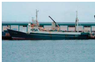
Klakkur SH 510 Skipaskr.nr.: 1472 Smiðaður: Póllandi 1977 stál Stærð: 488,00 btl; 745,00 bt Lengd: 51,83 m Breidd: 10,76 m Dýpt: 6,96 m Vél: B&W Alpha 1.620,00 kW Árgerð: 1987 Fjöldi skipverja: 15
