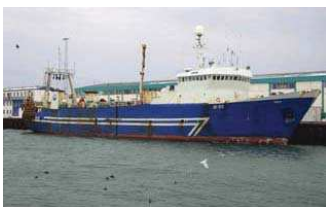
Venus HF 519 Skipaskr.nr.: 1308 Smíðaður: Spánn 1973 stál Stærð: 1.156,00 brl; 1.779,00 bt Lengd: 77,53 m Breidd: 11,60 m Dýpt: 7,50 m Vél: MaK 2.355,00 kW Árgerð: 1979 Fjöldi skipverja: 27
