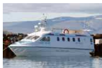
Skipaskr.nr. 2651 Smiðaður: Akranesi 2005, plast Stærð: 11,38 brl. 14,79 bt. Mesta lengd: 12,43 m Skráð lengd: 10,99 m Breidd: 3,95 m Dýpt: 1,5 m Vél: Yanmar 314 kW, 2005 Fjöldi skipverja: 4
