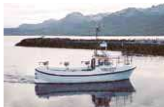
Skipaskr.nr. 7002 Smiðaður: Hafnarfirði 1987 plast Stærð: 6 brl. 4,9 bt. Mesta lengd: 7,73 m Skráð lengd: 7,65 m Breidd: 2,68 m Dýpt: 1,55 m Vél: FM 86 kW 2004 Fjöldi skipverja: 2
