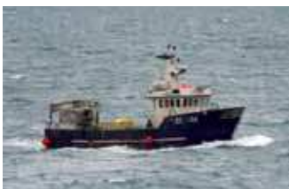
Skipaskr.nr. 1985 Smíðaður: Ytri-Njarðvík 1989 Stál Stærð: 17,4 brl. 23 bt. Mesta lengd: 16,1 m Skráð lengd: 14,4 m Breidd: 3,94 m Dýpt: 1,9 m Vél: Caterpillar 160 kW, 1989 Fjöldi skipverja: 2
