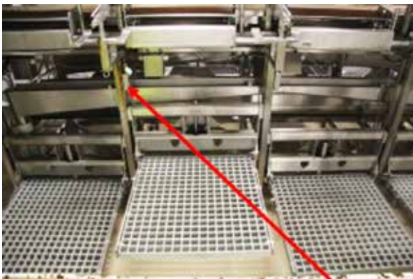
Pallar við snyrtiborð í öðru skipi en þar eru stjórnlokar ofarlega á borðfótum og engin lárétt styrktarstífa á milli borðfóta en því halda framleiðendur fram.
