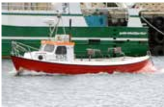
Skipaskr.nr. 6376 Smiðaður: Hafnarfirði 1982, plast Stærð: 4,8 brl. 5,6 bt. Mesta lengd: 9,08 m Breidd: 2,37 m Dýpt: 1,24 m Vél: Yanmar 66 kW 1999 Fjöldi skipverja: 1
