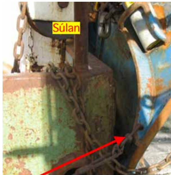
Sjóbúnaðarbrókinni krækt í hlerann eftir að slakað hafði verið í gilsinn en þá sigur innri hlið niður.
