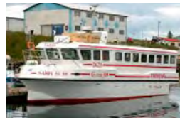
Narfi SU 68 Skipaskr.nr.: 2628 Smiðaður: Hafnarfirði 2004 plast Stærð: 11,50 brl; 14,50 bt Lengd: 12,25 m Breidd: 3,74 m Dýpt: 1,41 m Vél: Yanmar 314,00 kW Árgerð: 2004 Fjöldi skipverja: 2
