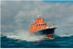
Hannes Þ. Hafstein Skipskr.nr.: 2310 Smíðaður: Englandi 1975 plast Stærð: 42,90 brl; 42,00 bt Lengd: 16,31 m Breidd: 5,20 m Dýpt: 2,70 m Vél: Caterpillar 544,00 kW Árgæð: 1974 Fjöldi skipverja:
