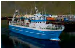
Brynjólfur VE 3 Skipaskr.nr.: 1752 Smíðaður: Akranesi 1987 stál Stærð: 299,00 brl; 831,50 bt Lengd: 41,98 m Breidd: 8,10 m Dýpt: 6,25 m Vél: Bergen Diesel 728,00 kW Árgerð: 1987 Fjöldi skipverja: 12
