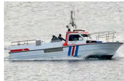
Aggi SI 8 Skipaskr.nr.: 6607 Smíðaður: Hafnarfirði 6607 plast Stærð: 5,90 brl; 5,70 bt Lengd: 8,45 m Breidd: 2,58 m Dýpt: 1,44 m Vél: Volvo Penta 119,00 kW Árgerð: 1999 Fjöldi skipverja: 1
