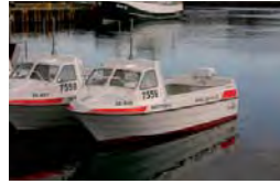
Hafyrðill ÍS 408 Skipaskr.nr.: 7559 Smíðaður: Hafnarfirði 2006 plast Stærð: 4,61 brl; 3,47 bt Lengd: 6,98 m Breidd: 2,34 m Dýpt: 1,52 m Vél: Volvo Penta 67,20 kW Árgerð: 2006 Fjöldi skipverja: 3
