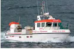
Steini GK 45 Skipaskr.nr.: 2443 Smiðaður: Hafnarfirði 2000 plast Stærð: 5,70 brl; 10,30 bt Lengd: 9,90 m Breidd: 3,40 m Dýpt: 1,27 m Vél: Yanmar 275,00 kW Árgerð: 2000 Fjöldi skipverja: 2
