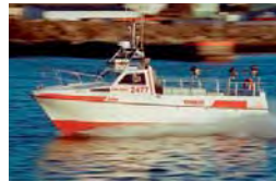
Vinur GK 96 Skipaskr.nr.: 2477 Smiðaður: Hafnarfirði 2000 plast Stærð: 6,40 brl; 6,00 bt Lengd: 8,73 m Breidd: 2,57 m Dýpt: 1,19 m Vél: Yanmar 257,00 kW Árgerð: 2000 Fjöldi skipverja:
